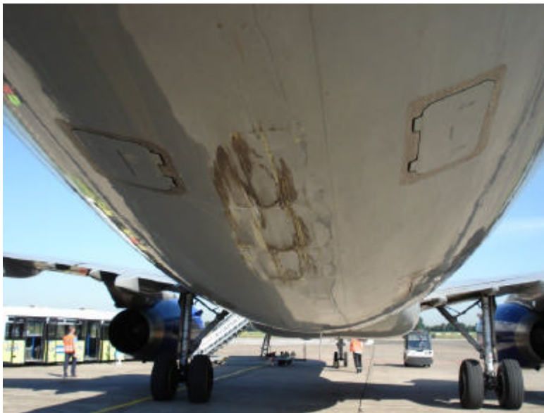
Afbeelding 2: staartvlak van TC-OAN met schaafplekken
