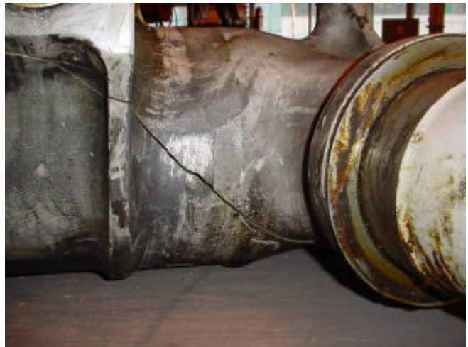
De scheur in het rechter MLG draaistel
