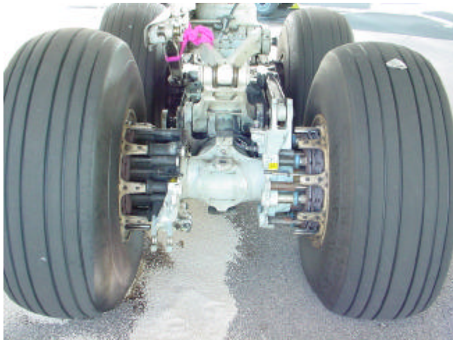
Het gebroken oor (linksonder) van het rechter MLG
