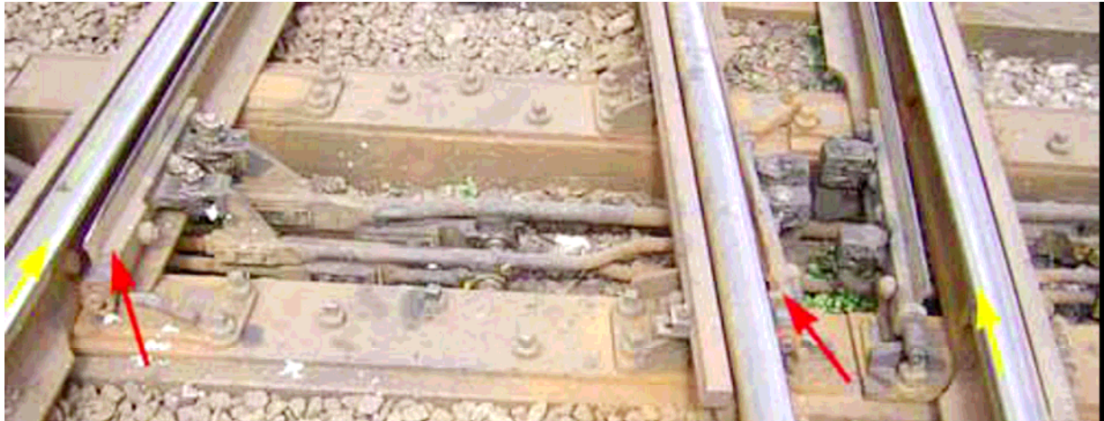
Afb. 8 Wissel 63B in de stand aangetroffen direct na de ontsporing. Hierop zijn duidelijk de openstaande tongen te zien.
