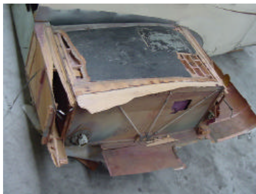
Beschadigde rechterkant romp
