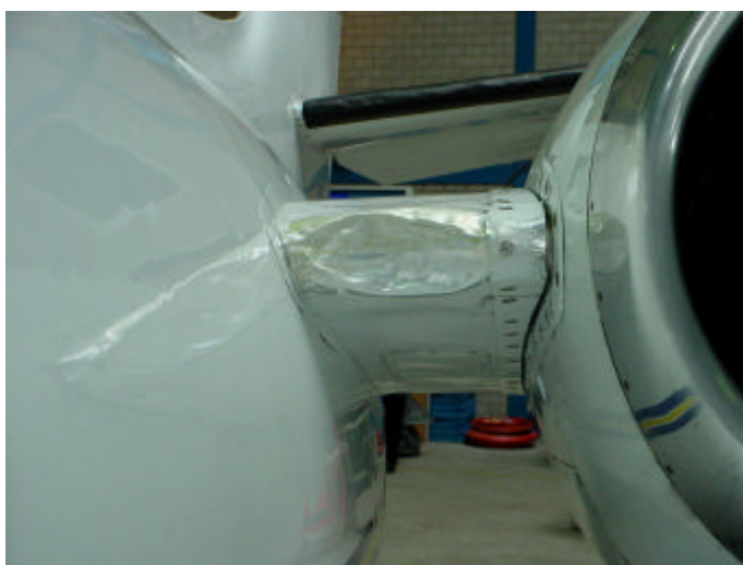
Ingedeukte aluminium huidbeplating
