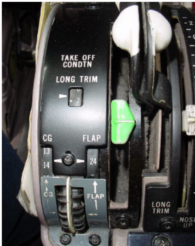
Afbeelding 2: consol van de take-off condition computer..
