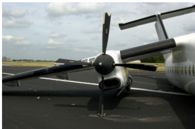
De beschadigde rechterkant
