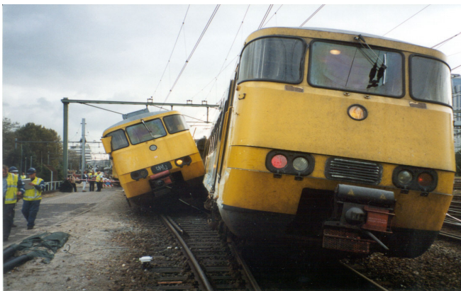
Figuur B10: Schematische sporensituatie. Op 16 september 2002 reed een rangeerdeel (sprinter II) voorbij roodtonend sein 252 en botste in wissel 253 zijdelings tegen een vertrekkende reizigerstrein (sprinter III). Voor de reizigerstrein was een rijweg ingesteld van spoor 14a naar spoor GA. Voor rangeerdeel stond een rijweg ingesteld van spoor 18 naar spoor 17a. Het rangeerdeel moest naar spoor GA en daarna weer terug naar perronspoor 3. Beoordeling ongeval: Het betrof een deelrijweg, die vermeden had moeten worden.
