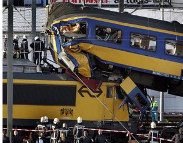
Figuur 1: Het omhoog geschoven eerste rijtuig achter de locomotief van de intercity.
