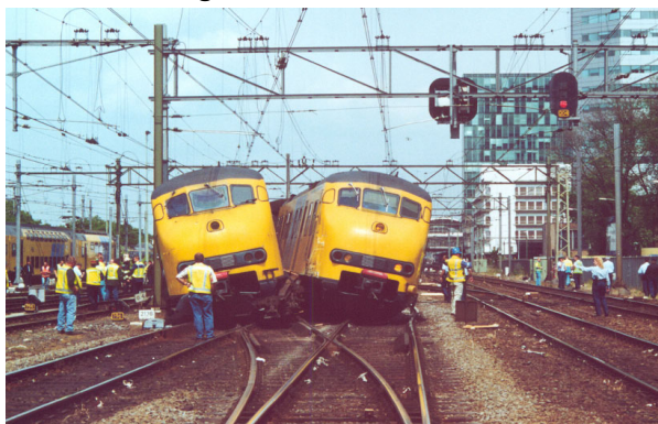
Figuur B4: Schematische sporensituatie. Op 13 juni 2001 reed reizigerstrein 6039 voorbij roodtonend sein 188 en reed ter hoogte van wissel 215B zijdelings tegen de binnenkomende reizigerstrein 19636. Van de binnenkomende trein brak de laatste rijtuigbak bij de balg af. Voor deze trein was een rijweg ingesteld van spoor GB naar spoor 15a. Voor de vertrekkende trein was een rijweg ingesteld van spoor 14a tot sein 188. De trein moest verder naar spoor GO. Beoordeling ongeval: Het betrof een deelrijweg, die in geen enkel geval toelaatbaar is. De deelrijweg is automatisch ingesteld.
