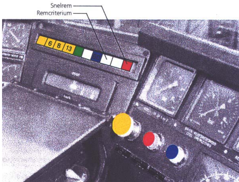
Afbeelding 4 De werkplek van een machinist met ATB-cabinesignalering
