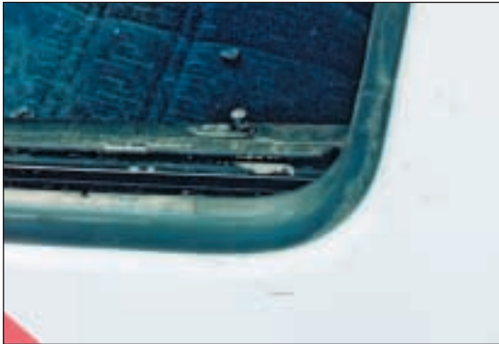
Figuur 3a (links): Linkerzijkant van het voertuig, deel van portier linksvoor. Zichtbaar (rechtsonder in het raam) is de afgebroken bedieningsknop van het portier, in uitgetrokken stand. Bron: politie.
