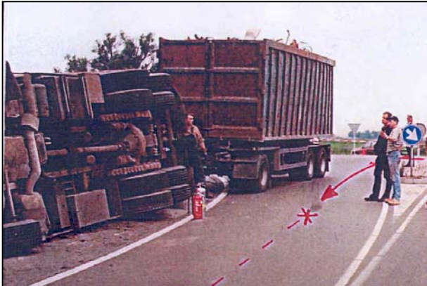
Figuur 4: Deze foto's tonen de eindsituatie. Het kantelen van de voorwagen werd veroorzaakt doordat de daarop geplaatste afzetbak aan de achterzijde verschoof (terwijl de voorzijde wel vastzat). Bron: Technische Verkeersanalyse van de Regiopolitie IJsselland.
