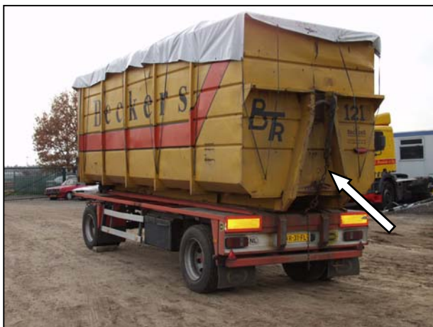
Figuur 5: Deze foto's tonen de aanhangwagen met afneembare laadbak. De pijlen wijzen naar de spaninrichting aan de achterzijde (die vanwege verbogen spindels niet kon worden gebruikt). Bron: Bureau Technische Ondersteuning van de Regiopolitie Limburg-Noord.
