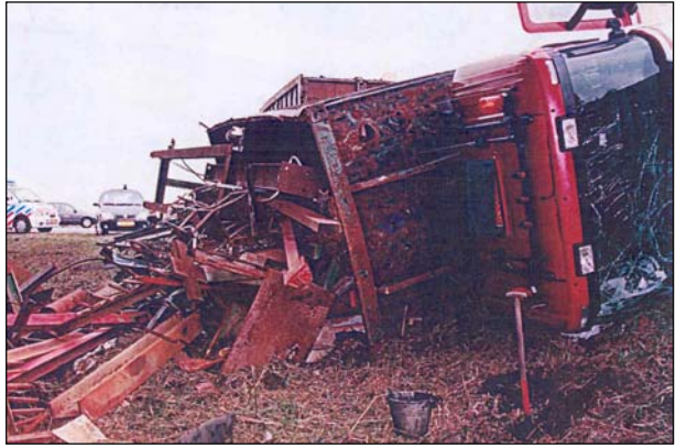
Figuur 4: Deze foto's tonen de eindsituatie. Het kantelen van de voorwagen werd veroorzaakt doordat de daarop geplaatste afzetbak aan de achterzijde verschoof (terwijl de voorzijde wel vastzat). Bron: Technische Verkeersanalyse van de Regiopolitie IJsselland.
