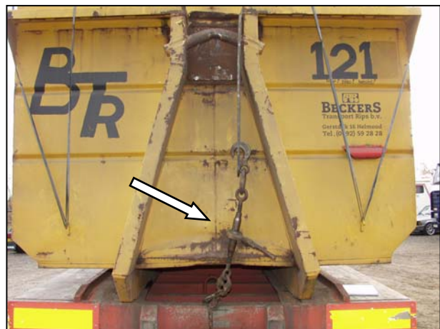
Figuur 5: Deze foto's tonen de aanhangwagen met afneembare laadbak. De pijlen wijzen naar de spaninrichting aan de achterzijde (die vanwege verbogen spindels niet kon worden gebruikt). Bron: Bureau Technische Ondersteuning van de Regiopolitie Limburg-Noord.
