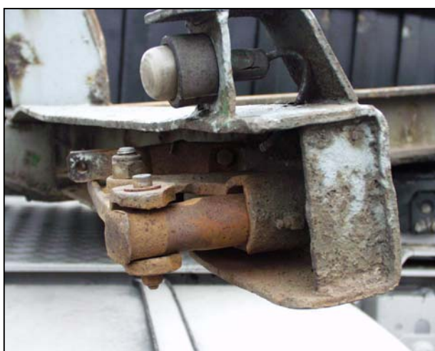
Figuur 3: De bovenste foto toont de eindpositie. Op de onderste foto's is te zien dat het mechanisme voor het vastzetten van de container op de oplegger in extreme mate 'versleten' was. Bron: Verkeersongevallendienst van de regiopolitie Gelderland-Midden.
