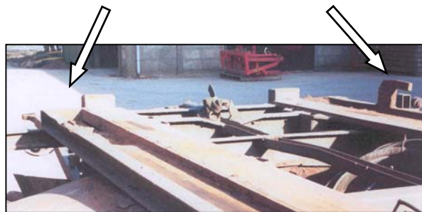
Figuur 6: De foto linksboven toont de afzetbak (nadat deze was teruggezet) op de aanhangwagen. Op de onderste foto is te zien dat op de linker-voorhoek van de aanhanger de borgingsnok ontbreekt. Die borgingsnok, die over de uitstekende astap van de afzetbak hoort te vallen (zie foto rechtsboven) was – getuige de roestvorming op het breukvlak – reeds geruime tijd eerder afgebroken. Bron: Verkeersongevallendienst van de Regiopolitie Flevoland-Noord.
