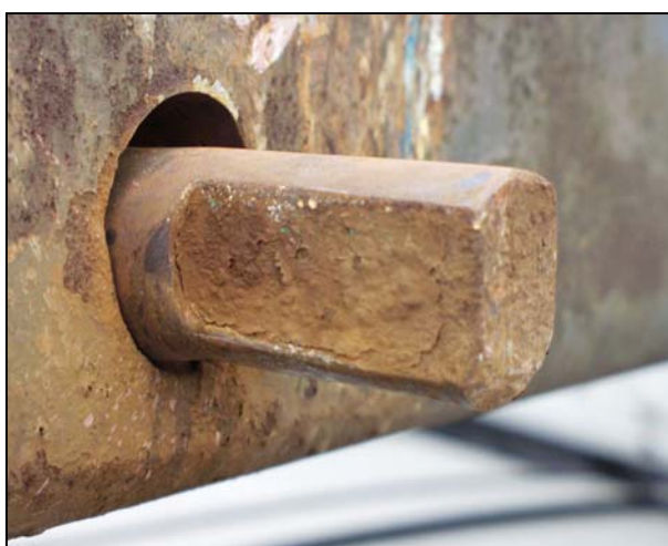
Figuur 3: De bovenste foto toont de eindpositie. Op de onderste foto's is te zien dat het mechanisme voor het vastzetten van de container op de oplegger in extreme mate 'versleten' was. Bron: Verkeersongevallendienst van de regiopolitie Gelderland-Midden.
