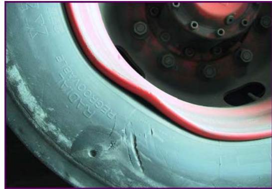
Figuur 2: Op de linker foto is de dubbele rij trottoirbanden te zien (waarmee het rechter-achterwiel van de bus op enkele honderden meters voor het bereiken van de overweg in aanrijding is gekomen). De rechter foto toont de schade die daardoor aan de bus is ontstaan. Bron: Regiopolitie Haaglanden.
