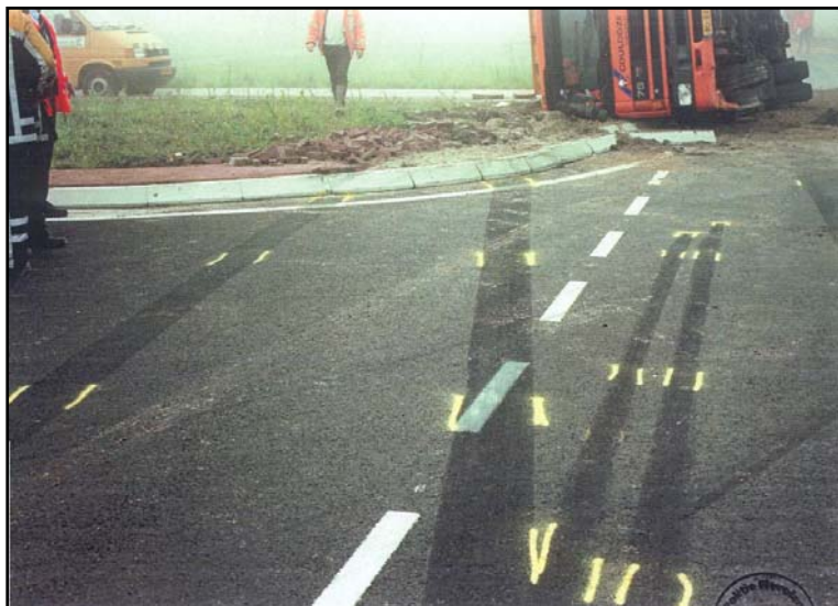
Afb. 1: Deze foto toont de eindsituatie van het ongeval in Dronten. Op de achtergrond is de vrachtauto te zien, die achterstevoren en op de rechterzijde liggend tot stilstand is gekomen. Op de voorgrond is het laatste deel te zien van de bandensporen die de vrachtauto heeft achtergelaten.
