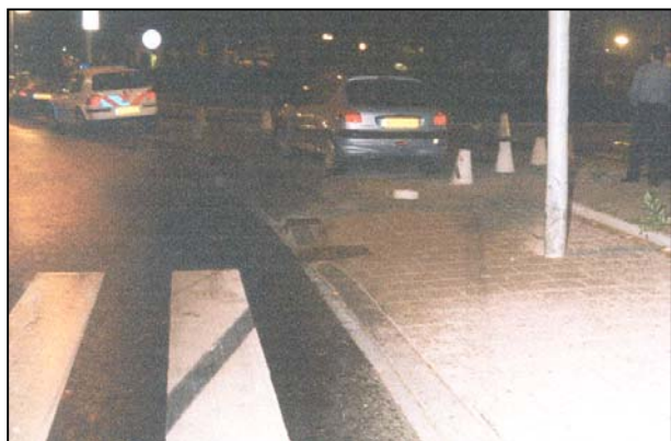
Afb.3: Eindsituatie van het ongeval op de Willem de Zwijgerklaan. Op het midden van de foto is betreffende personenauto te zien, alsmede de beide betonnen palen waarmee het voertuig in botsing is gekomen. Op de voorgrond is het laatste deel zichtbaar van de blokkeersporen die de auto voorafgaande aan de botsing heeft achtergelaten
