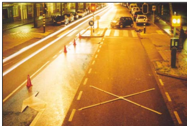
Afb. 4 Eindsituatie van het ongeval op de Jan van Galenstraat. De aanrijding heeft kort voor het zebrapad plaatsgevonden. De auto is net voorbij het zebrapad en ongeveer achterstevoren tot stilstand gekomen. Als de vertraging (i.p.v. minder dan 4 \text{ m/s}^2 ) ongeveer 7 \text{ m/s}^2 had bedragen, dan zou de auto bijna 10 meter eerder tot stilstand zijn gekomen en de aanrijding niet hebben plaatsgevonden.
