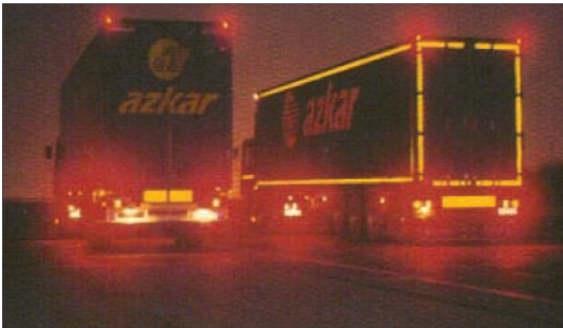
Figuur 9: Foto van vrachtauto's met en zonder retro-reflecterende contourmarkering. (Bron: 3M)
