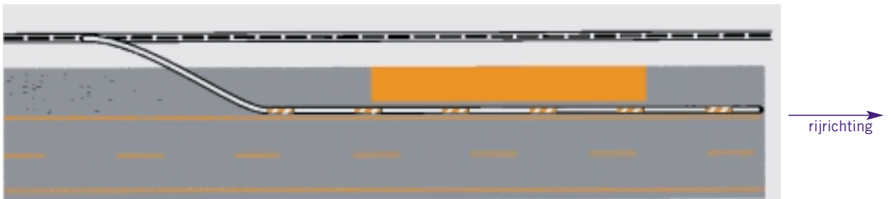
(a) Koppelen van de tijdelijke barrier aan de permanente middengeleiderail
