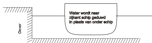
Figuur 2-5 Uitleg voor het ontstaan van een "bow out" giermoment (boeg-van-de-oever-weg) en oeverzuiging
