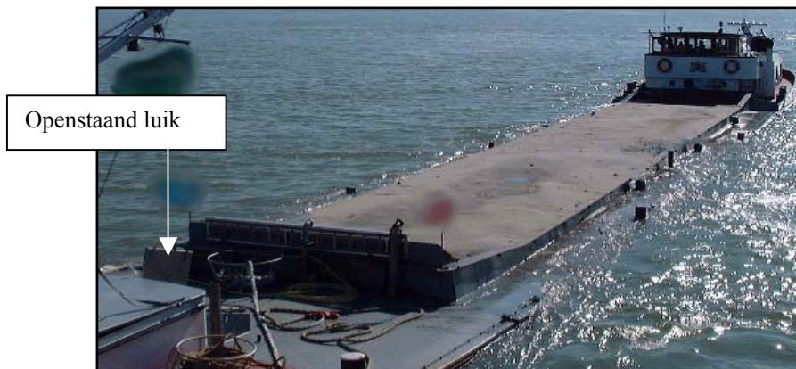
Figuur 10: Foto van een te diep afgeladen beunschip met tevens een openstaand inspectieluik
