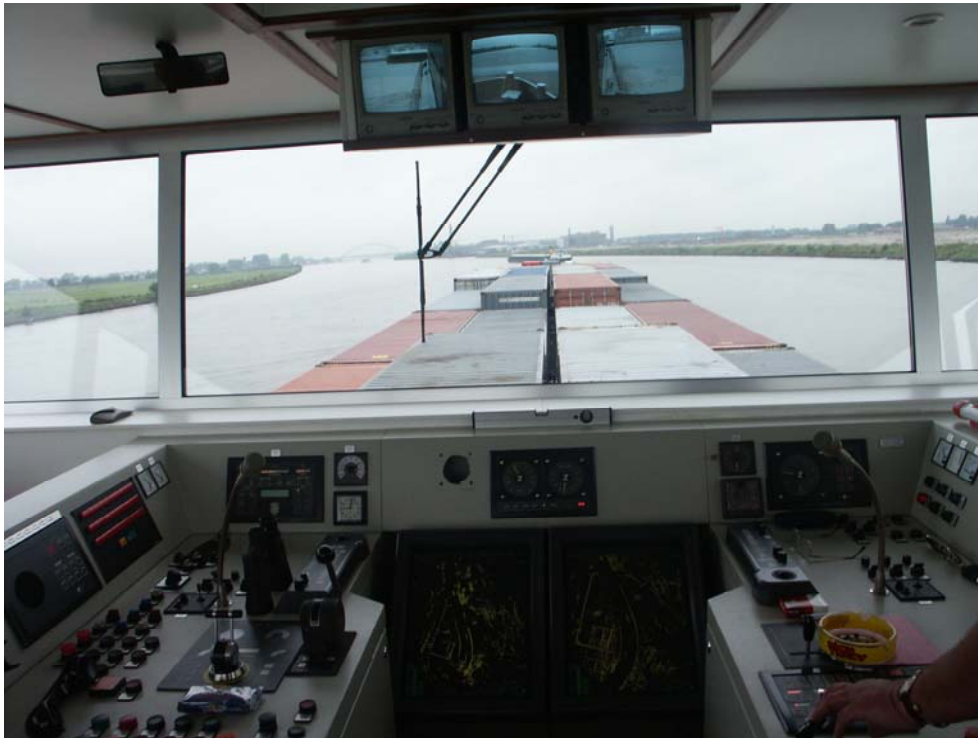
Fig. 8 Overzicht van een stuurhuis. Het directe uitzicht toont al aan dat er voor het schip een dode hoek (zone) is. Te zien is dat er zich op afstand een schip bevindt. Aan het dak zijn drie monitoren opgehangen die respectievelijk een beeld geven van bakboordzijde, voor het schip en stuurboordzijde. De radarschermen zijn hier midden onder geplaatst (vrijwel niet zichtbaar op de foto).
