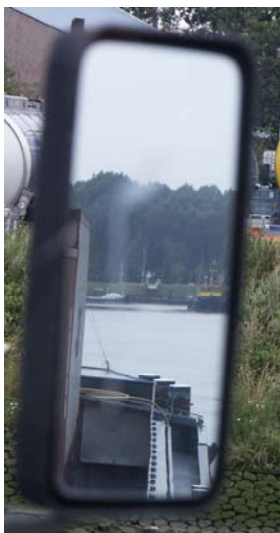
Fig. 2 Door de toepassing van vlakke spiegels, bezijden het stuurhuis, wordt vanuit de positie van de schipper het schip langzij voorwaarts (of achterwaarts) overzien. Met de vlakke spiegel heeft men een onvertekend beeld.
