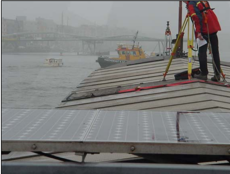
Figuur 1: Foto van een meetopstelling met een Total-station aan boord van een binnenschip.
