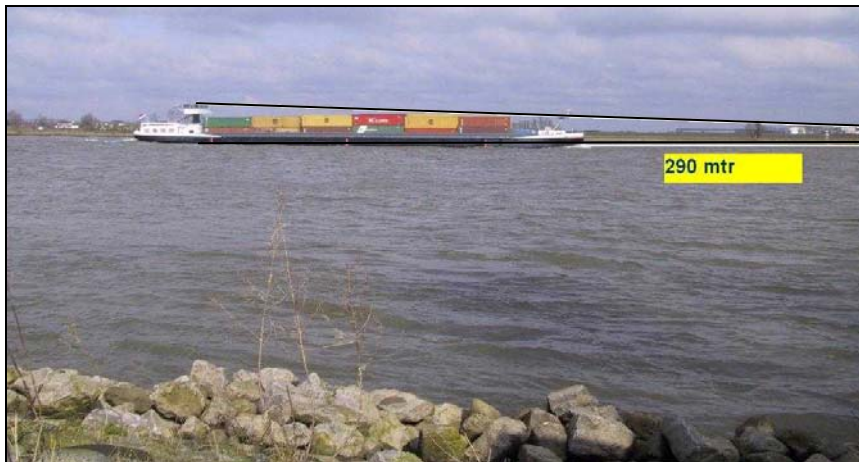
Figuur 6: Voorbeeld van het inmeten van een schip met fotometrie.
