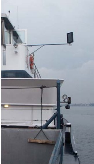
Fig. 5 Aan bakboordzijde is boven de vlakke uitzichtspiegel te zien die gekoppeld is aan het (hefbare) stuurhuis. Deze spiegel geeft een uitzicht langszij naar voren. Beneden bevindt zich een vaste opstelling van de bakboordcamera en een schijnwerper.
