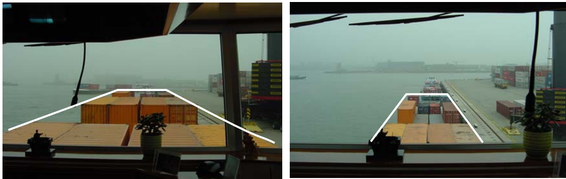
Figuur 16: De linkerfoto toont het zicht vanaf ooghoogte van de roerganger met het stuurhuis op operationele hoogte (zoals het schip kwam aanvaren). De rechter foto toont het zicht vanaf ooghoogte van de roerganger met het stuurhuis in de hoogst mogelijke hefstand. De witte lijnen geven waar de zichtgrenzen liggen als het schip volledig met containers beladen zou zijn.
