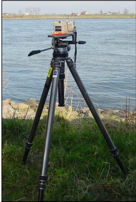
Figuur 5: Opstelling van de digitale camera ten behoeve van de meting door middel van digitale fotometrie
