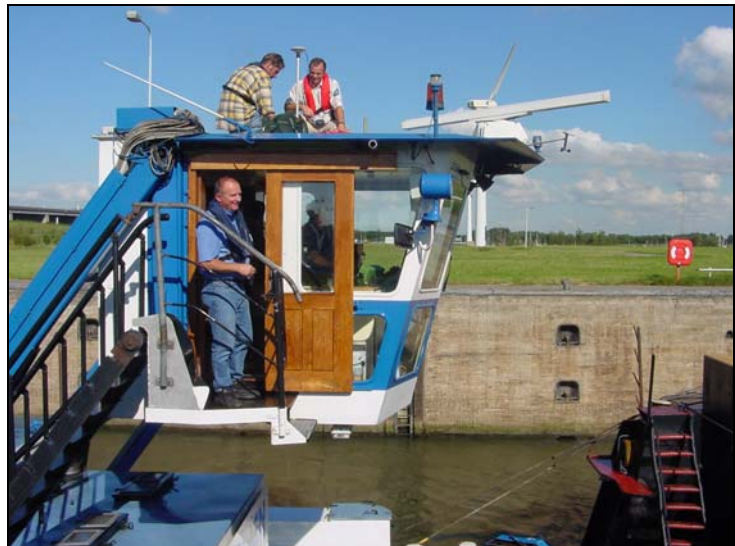
Figuur 4: Een tweede GPS-antenne wordt geplaatst en ingemeten op de ooghoogte van de roerganger.
