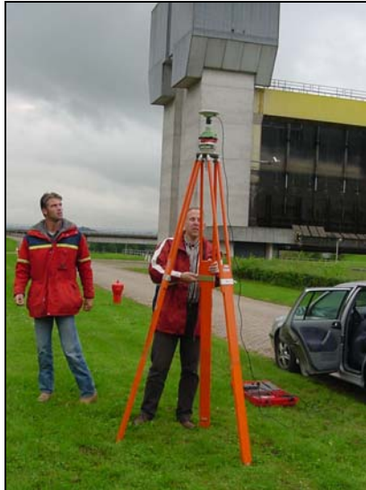
Figuur 2: Door de plaatsing van een grondstation wordt een grote meetnauwkeurigheid bereikt.
