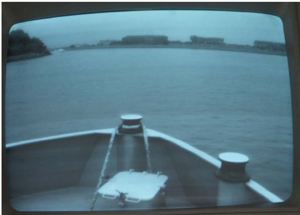
Fig. 7 Het beeld van de camera vanaf de voormast. Deze opstelling geeft zowel een deel van het voorschip—als vaste referentie—alsmede het dode hoek zicht voor het schip. Opvallend is dat bij camera's met een wat grotere beeldhoek geometrische vervorming op de monitor zichtbaar wordt (sectie 5.4), hetgeen boven in beeld is te zien: de horizon wordt gebogen weergegeven.
