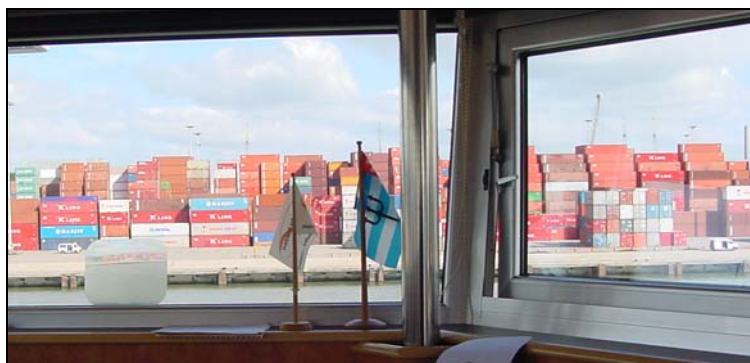
Figuur 17: Zijdelijks zicht vanuit de positie van de roerganger met een hefbaar stuurhuis in de hoogste stand (de ooghoogte van de roerganger op circa 14 meter boven het wateroppervlak).
