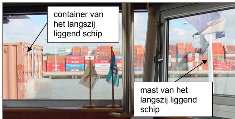
Figuur 19: Zijdelings zicht vanuit de positie van de roerganger op het schip uit figuur 17 en 18. Het stuurhuis staat in de laagste stand (circa 5 meter boven het wateroppervlak). Nu pas wordt de lading en de mast van een ander schip zichtbaar die met het stuurhuis in volledig of deels geheven stand niet zichtbaar waren.
