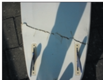
Figuur 3: Beschadiging zeilplank onderaanzicht
