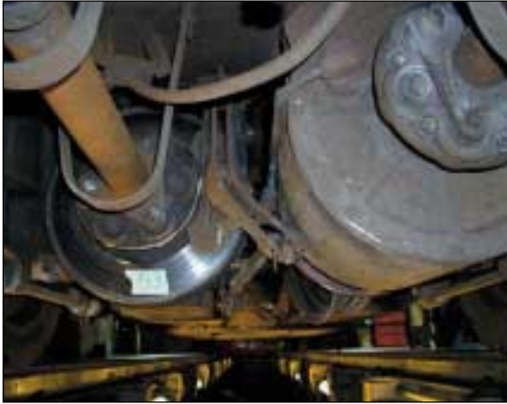
Afb. 6 De motor in het draaistel. Links en rechts beneden in het donkere deel van de foto zijn nog net de wielen zichtbaar.
