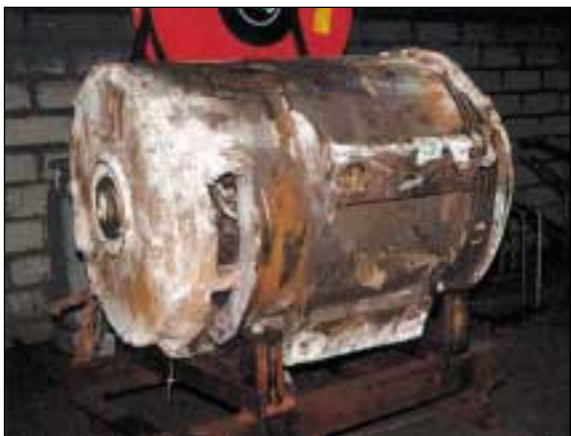
Afb. 4 De afgevalen en beschadigde motor in de werkplaats.
