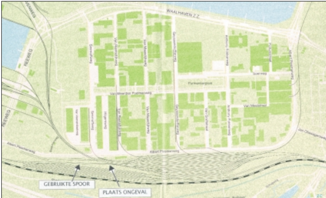
Afb. 2 Rangeerterrein Waalhaven met verbindingssporen naar bedrijven. Bij kopspooren is geduwd rangeren onvermijdelijk.
