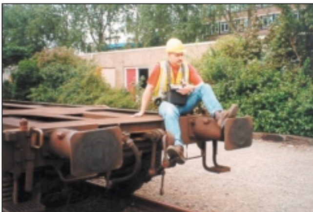
Afb. 4 Positie radioloc-bestuurder. Het bedieningskastje draagt hij voor zich.
