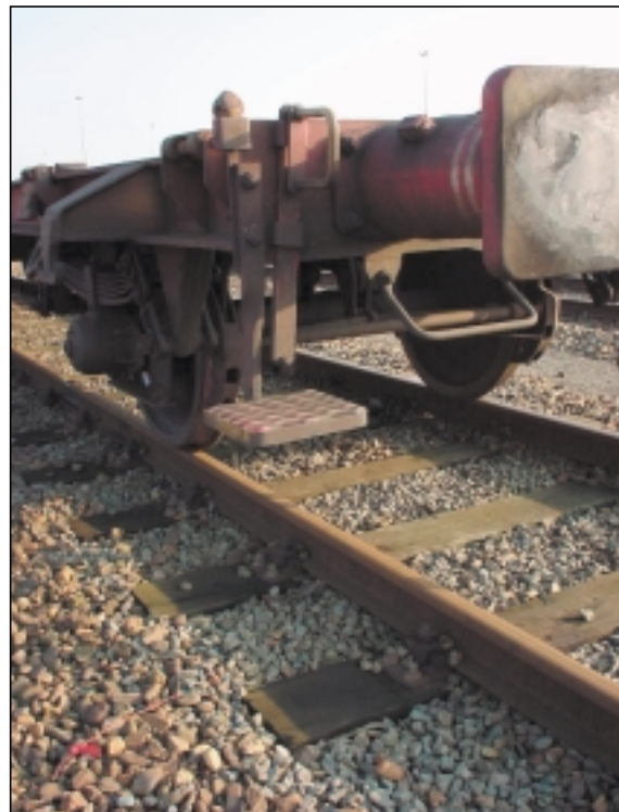
Afb. 8 De internationaal genormeerde opstapvoorziening aan de goederenwagen. De handgreep wordt eerst omhoog getrokken. Daarna fungeert hij als steun.
