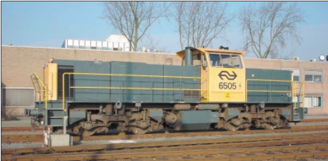
Afb. 7 De op afstand door radiosignalen bestuorde locomotief van Railion. Op de achtergrond het kantoorgebouw, waarin zich de verkeersleiderspost bevindt.
