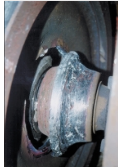
Afb. 7 Het gescheurde binnenwiel.
