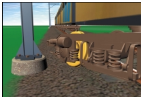
Afb. 3 Het draaistel botst tegen de bevoering van een overweg in het enkelsporige baanvak en draait volledig uit. Daarbij komt het buiten het profiel van vrije ruimte.
