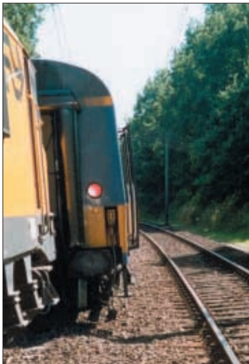
Afb. 3. De naar links ontspoorde intercity na de overwegbotsing te Bunde.
