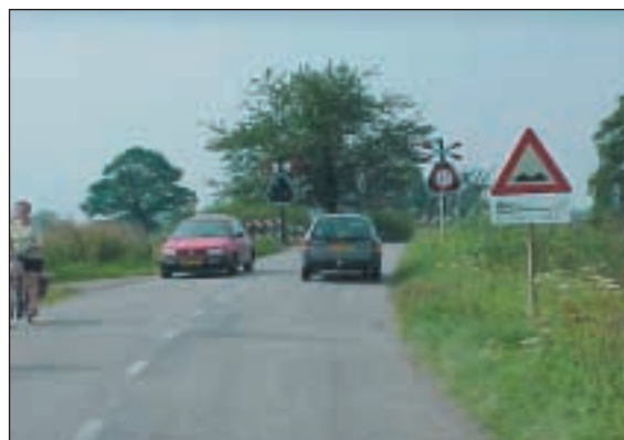
Figuur 6. Het wegbeeld voor de spoorwegovergang in de Broekstraat. De twee verkeersborden F5 ('Verbod door te gaan bij nadering tegenliggers') en J1 ('Slecht wegdek/diepladergevaar') belemmeren het zicht en het bord J1 heeft reeds lang zijn betekenis verloren. De rechter personenauto staat op de plaats waar de tractor met hooischudder stond.
