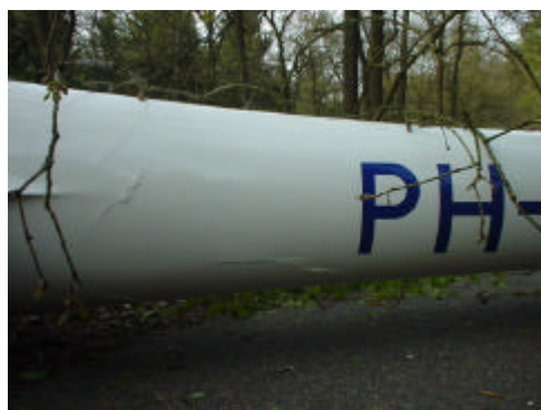
Schade aan de romp
