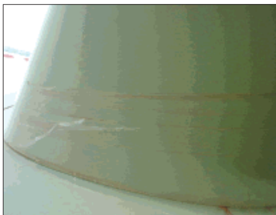
Afb. 7 Sporen van de sleepkabel aan onderzijde vleugel en vleugelwortel PH-952
