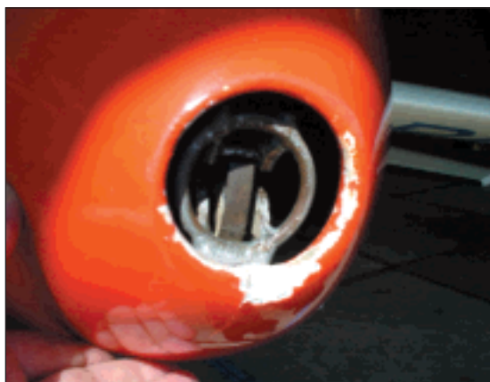
Afb. 9 Schade aan neus PH-561
