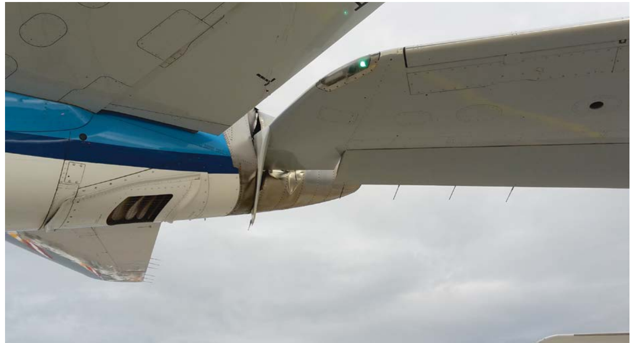
Schade aan staart PH-EZB en vleugeltip D-AKNU. (Foto: BFU)
