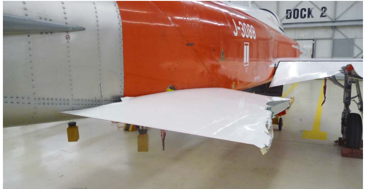
Schade aan het rechterstabilo van de J-3088.
