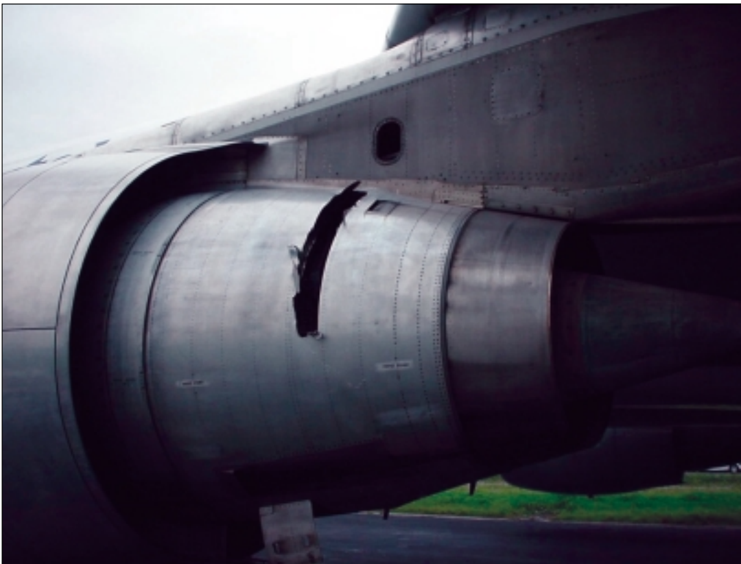
Figuur 6: Gat in de motorbehuizing veroorzaakt door weggeslingerde statorschoepsegmenten uit de tweede trap van de lagedrukturbine.
